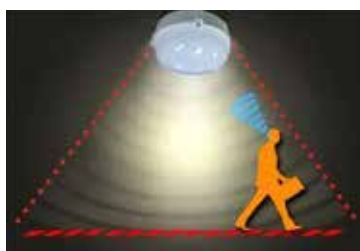
Светильник включается на 100% при появлении движущегося объекта в радиусе 5 м
