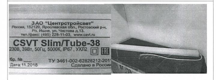
Испытания проведены на соответствие требованиям ГОСТ IEC 60598-1-2013 по степени защиты IP67,используя методику проведения испытаний по ГОСТ 14254-2015.
