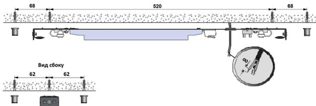
3. Закрепить платик и втулки корпусов для тросовых подвесов на поверхности потолка с помощью комплекта крепежа X4 (не входит в комплект поставки).
