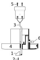
2. Провести сетевые провода (3) через отверстие в основании светильника (4) и подключить их к ламподержателю, соблюдая полярность.
