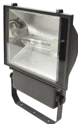
**Описание светильника** Пристраиваемый прожектор с симметричным рифленым отражателем и стеклянным рассеивателем под металлогалогенную лампу с цоколем E40, степень защиты IP65. Очень большой световой поток.
