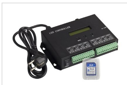
RGB SPI-контроллеры с записью программ на SD-карту с помощью ПО Led Build
