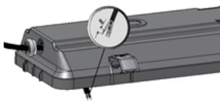
4. Подключить сетевой провод к клеммной колодке на монтажной панели в соответствии с указанной полярностью.
