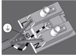
5. При використанні регульованого драйвера, керуючі провoda підключаються строго з дотриманням полярності, вказаної в маркуванні.
