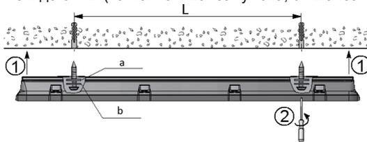
2.2. Установка на підвісах. Просвердлити установчі отвори у корпусі світильника на відстані L: (на мал. a - шайба металева М6; b - шайба гумова; c- гайка М6)
