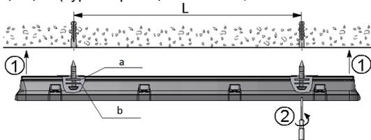
2.2. Аспада орнатылуы. шамшырақ корпусында L қашықтықта орнату тесіктерін бұрғыланыз : (сур. a – резеңке шайбасы; b - металл шайбасы M6)
