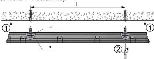
2.2. Установка на подвесах. Просверлить установочные отверстия в корпусе светильника на расстоянии L: (на рис. a - шайба металлическая М6; b - шайба резиновая; c- гайка М6).
