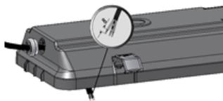
4. Підключити мережевий провід до клемної колодки на монтажній панелі відповідно до зазначеної полярності.
