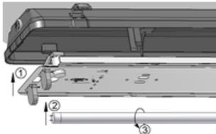
8. Одягнути розсіювач на корпус світильника та закріпити його защіпками.
