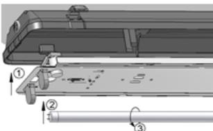
8. Одеть рассеиватель на корпус светильника и закрепить его защелками.
