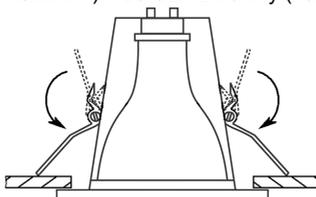
10. Закрепить рассеиватель (рамку), защелкнув его в корпусе с помощью пружин (выносное стекло – с помощью винтов или пружин).
