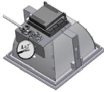
3.2.1. Мережевий провід провести через кабельний затиск і підключити до клемної колодки відповідно до зазначеної полярності (клемна колодка знаходиться на корпусі світильника).
