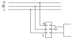
2. Схема підключення світильника до мережі живлення з блоком резервного живлення: (на мал. а - світильник, б - блок резервного живлення).
