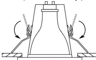
10. Закріпити розсіювач (рамку), защелкнув його в корпусі за допомогою пружин (виносне скло - за допомогою гвинтів або пружин).
