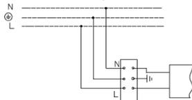
2. Шамдалдың резервтік қуаттандыру блогы бар қуаттандыру желісіне қосылу сызбасы (суретте a - шамдал, b - резервтік қуаттандыру блогы).
