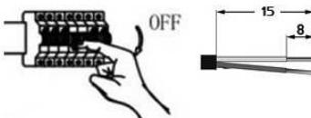
4. Підключити мережевий провід до клемної колодки світлодіодного драйвера згідно схеми, дотримуючись умов полярності: «L» - фаза, «N» - нуль, попередньо відкрутивши захисну кришку. Встановити та закрутити захисну кришку на драйвер.
