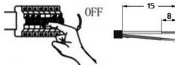
4. Подключить сетевой провод к клеммной колодке светодиодного драйвера согласно схемы, соблюдая условия полярности: «L» – фаза, «N» – ноль, предварительно открутив защитную крышку. Установить и закрутить защитную крышку на драйвер.
