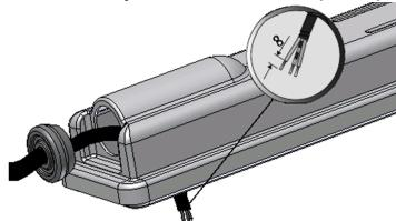
5. Підключити мережевий провід до клемної колодки відповідно до зазначеної полярності.
