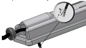
5. Подключить сетевой провод к клеммной колодке в соответствии с указанной полярностью.
