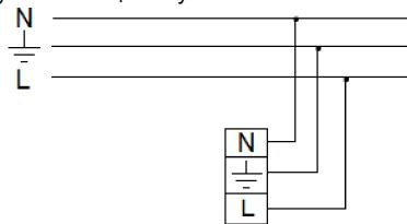
2. Резервтік құаттандыру блогы бар құаттандыру желісіне қосу сұлбасы : (сур. а - Резервтік құаттандыру блогы).
