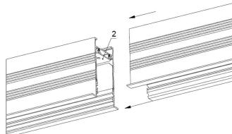
6.2. Переместить соединительную стяжку на соседний корпус, зафиксировать положение 2-мя винтами M4x8. Момент затяжки не более 0,4 Нм.
