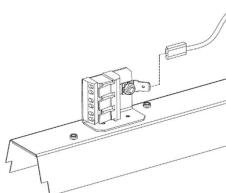
10. Қуат пен басқару сымдарын көрсетілген блокқа сәйкес терминал блогына қосыңыз. Басқару сымдарының (DA-DA) полярлығы бей-жай. Іске қосылған LED модулін шамшырақтың түркысына орнатыңыз, шашыратқыш пен түпкілікті қақпақтарды орнатыңыз. Жарық сзызықтары үшін түпкілікті қақпақшалар бірінші және соңы шамшырақтарға орнатылады.
