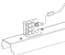
10. Подключить провода питания и управления к клеммной колодке в соответствии с указанной полярностью.
