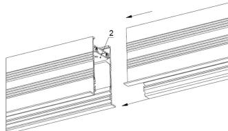
6.2. Перемістити сполучну стяжку на сусідній корпус, зафіксувати положення 2-мя гвинтами M4x8. Момент затяжки не більше 0,4 Нм.
