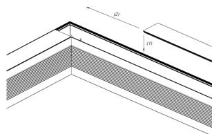
13. Стыковку рассеивателей в угловых версиях следует производить под углом 90 градусов, как показано на рисунке. При этом ножки длинного рассеивателя необходимо спилить на 3-5 мм напильником либо кусачками.
