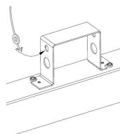
9. Для заземления корпусов светильников соединить провод заземления, идущий от каждого корпуса с клеммой заземления колодки.
