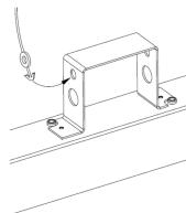
9. Для заземлення корпусів світильників з'єднати дріт заземлення, що йде від кожного корпусу з клемою заземлення колодки.
