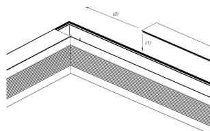
13. Стикування розсіювачів в кутових версіях слід проводити під кутом 90 градусів, як показано на малюнку. При цьому ніжки довгого розсіювача необхідно спилляти на 3-5 мм напилком або кусачками.
