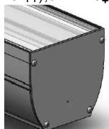
3. Бекіткіш пластиналарды шамшырақтың жаңындағы ойыққа жалғау ( а- пластинасы).
