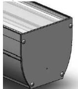
3. Вставити фіксуючі пластини в бокові пази профілю світильника (а - пластини).
