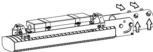
4. Установить кожух, затянув винты (поз.1)
