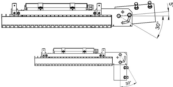
3. За допомогою чотирьох болтів М8х35 встановити світильник на опору (момент затягування 9 Н. м).
