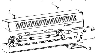
2. Выбрать нужное положение кронштейна, отрегулировать положение светильника, выставив нужный угол (шаг 5 градусов), затянуть болты (момент затяжки 9 Н.м.).
