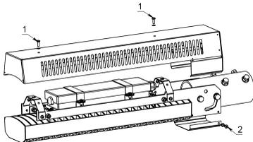
2. Вибрати потрібне положення кронштейна, відрегулювати положення світильника, виставивши потрібний кут (крок 5 градусів), затягнути болти (момент затягування 9 Н. м).
