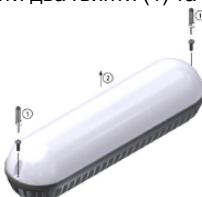
3. Відкрутити два гвинти (1) та зняти платік / світлодіодний кластер (2) (Не торкаючись та не пошкоджуючи світлодіодів).
