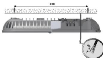
5. Закріпити корпус на поверхні стелі за допомогою комплекту кріплення X5 (не входить в комплект постачання), попередньо вдягнувши на гвинти гумові шайби (входять в комплект постачання). Для світильників з датчиком руху висота установки становить 1,5 - 3,5 м.
