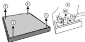
2. Вклацнути опору в корпус світильника.
