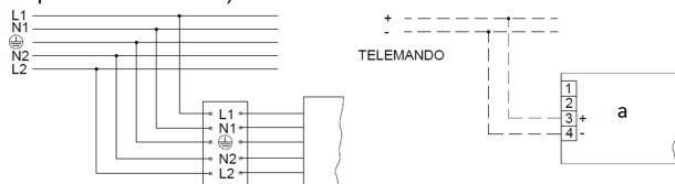
3. Схема підключення світильника до мережі живлення з регульованим драйвером за системою 1-10 V або системою DALI.
