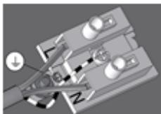
6. Полярность подключения проводов «+» и «-» сети постоянного тока к клеммам L и N не нормируется.
