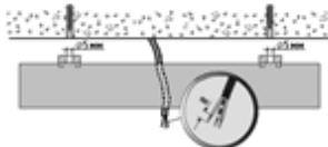
4. Установить корпус на поверхность потолка.
