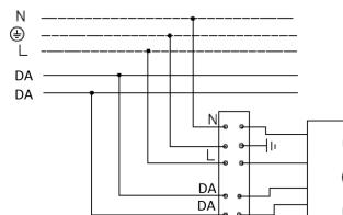
4. Схема подключения светильника к питающей сети с блоком резервного питания.
