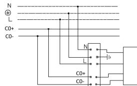
3. Схема подключения светильника к питающей сети с регулируемым драйвером по системе DALI.
