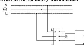
2. Шамшырақты 1-10V системасы арқылы реттеулі қуат беруші сымға жалғау схемасы.
