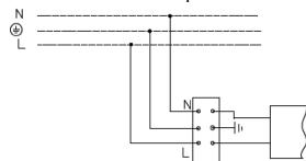
2. Схема подключения светильника к питающей сети с регулированием по системе 1-10V.
