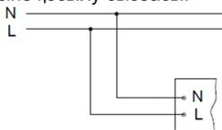
2. Шамдалдың резервтік қуаттандыру блогы бар қуаттандыру желісіне қосылу сызбасы (суретте а - шамдал, b - резервтік қуаттандыру блогы).
